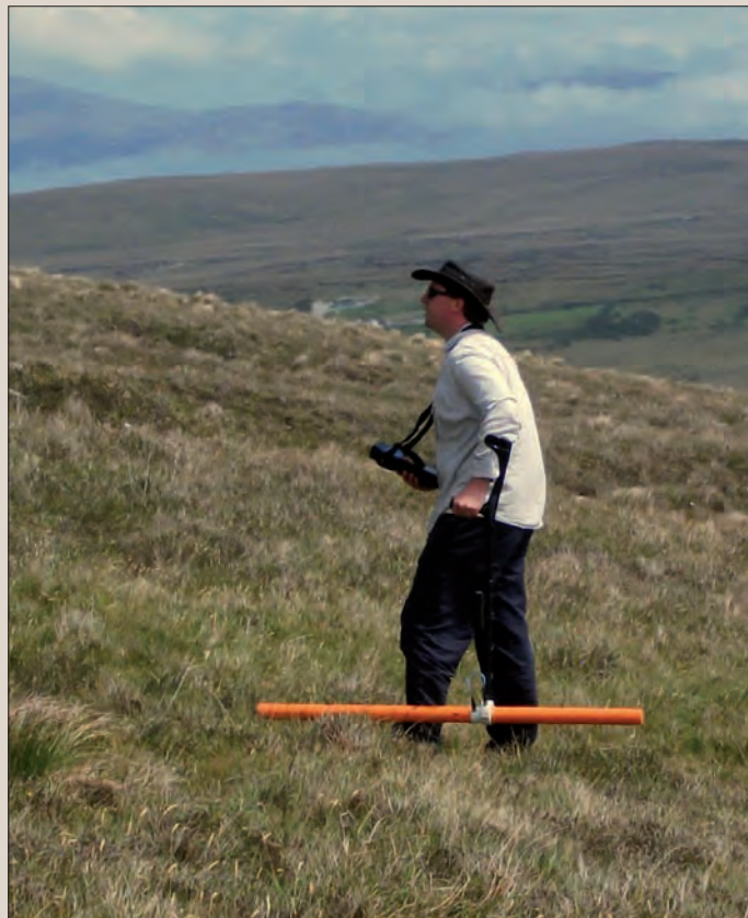
An teicneolaíocht is déanaí – sa chás seo gléas nua leictreamaighnéadach – in úsáid ag an údar le measúnú an bhfuil sé fóirsteanach do scéimeanna bóthair. (Íomhá: Clár Comhaltachta an ÚBN, Ollscoil Bradford)
